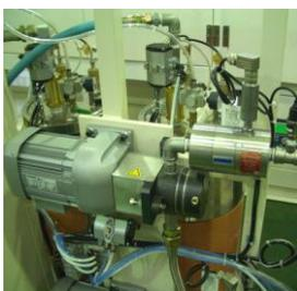
流量計、回転センサーを用いた吐出量管理システム
