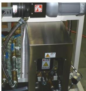
テクミックの高圧水洗浄システムは、洗浄液タンクより供給された水道水を、洗浄ポンプにて高圧水にしてミキシングヘッドの混合部に噴射させ、ノズル内のみ水道水にて、自動洗浄を行うシステムです。
