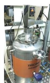
真空ポンプ、材料攪拌タンク、タンクヒーター、ホースヒーター
