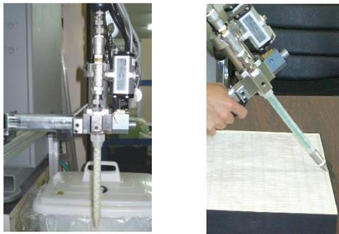
回転スタティック式ミキシングヘッドは、スタティックミキサーの内部を回転させることで、固定式のスタティックミキサーでは攪拌が難しい材料の混合が可能です。
