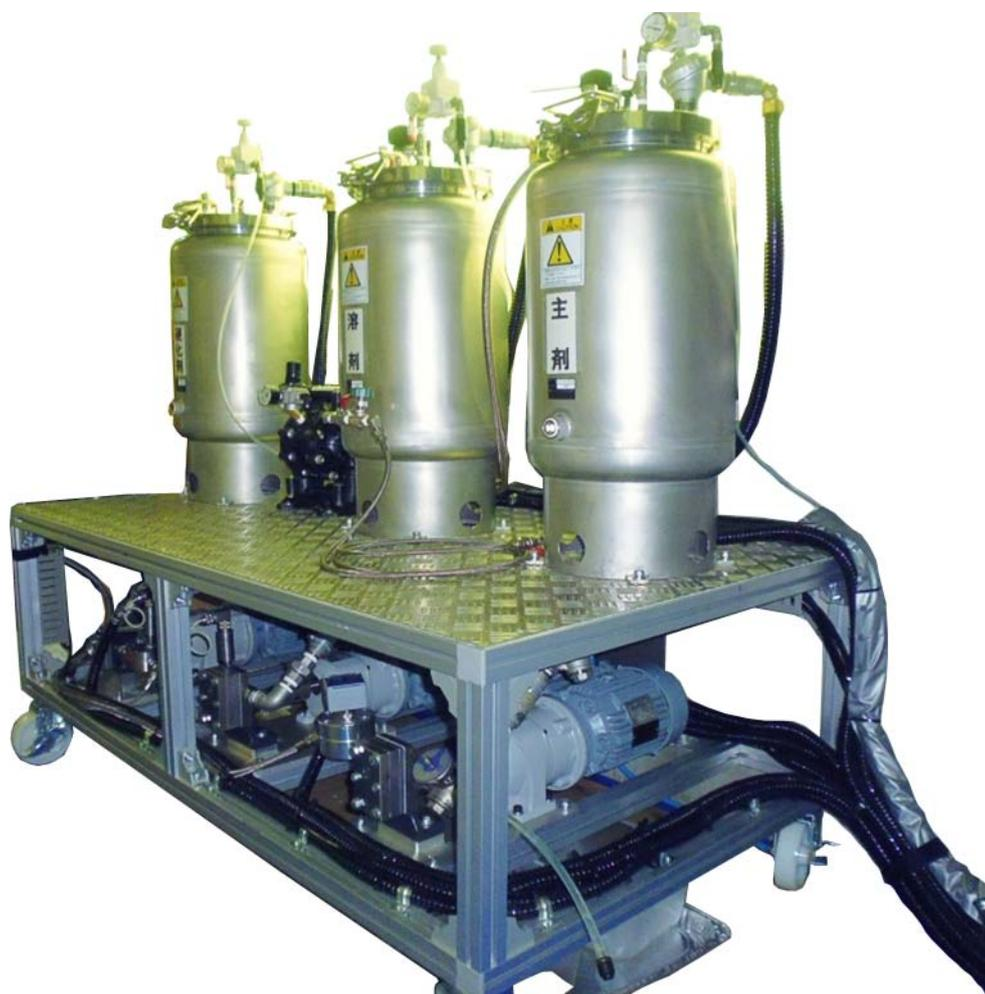
ドライラミネート用 3液混合吐出装置
