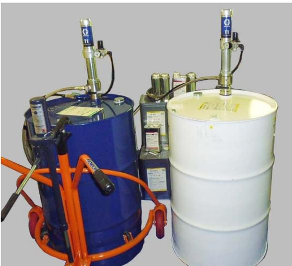
材料の供給は主剤はドラム缶より、硬化剤は一斗缶より酢酸エチルは工場外の貯蔵タンクより供給が可能です。
