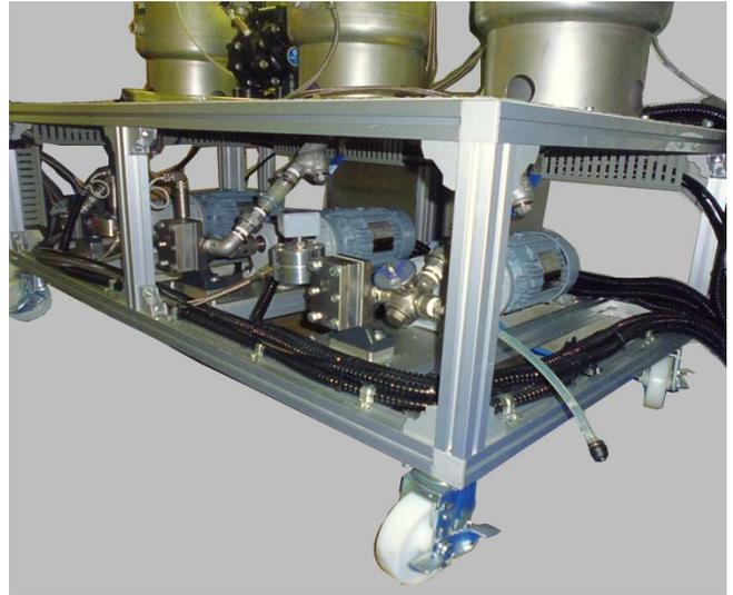
各材料はギアポンプによる定量吐出にて送液され、吐出時の流量を、流量計により常時監視を行っています。
